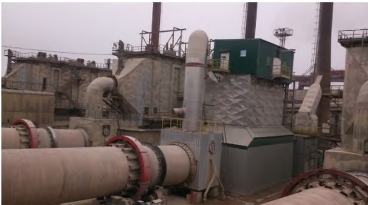
Фото 6.2. ПАТ “ХайдельбергЦемент Україна”. Сучасні очисні споруди для сушильного барабану № 2 з ефективністю очистки 99,9 %
