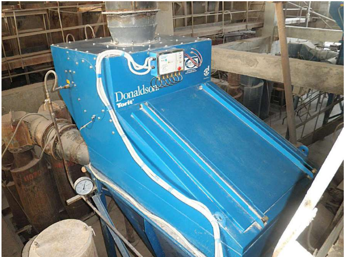
Фото 6.2. Філія “Вільногірський гірничо-збагачувальний комбінат” ПАТ “Об’єднана гірничо-хімічна компанія”. Встановлений фільтр Donaldson, що працює на млині по подрібненню циркону. Ступінь очищення при подрібненні збільшилась на 5,05% і майже досягла 100%.
